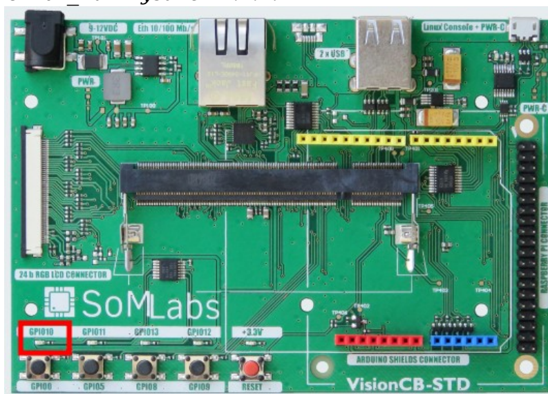
Rys. 2.2.1. Lokalizacja diody LED podłączonej do wyprowadzenia GPIO1_10
